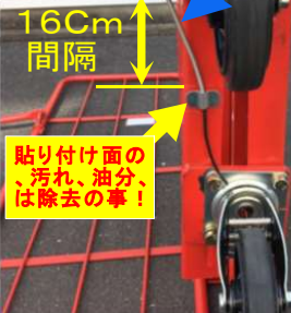
保護板(KH03)とケーブル挿入拡大写真
